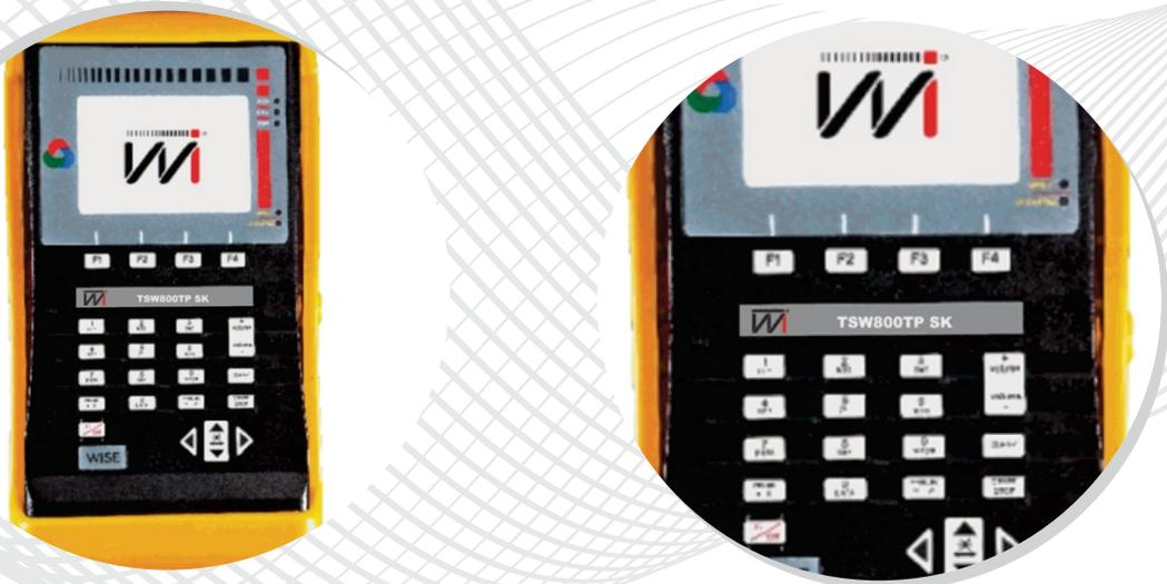
**O TSW800TPsk reúne características de seus antecessores, tais como os testes de desempenho nas tecnologias ADSL/ADSL2/ADSL2+, incluindo também testes de navegação e conectividade.**
