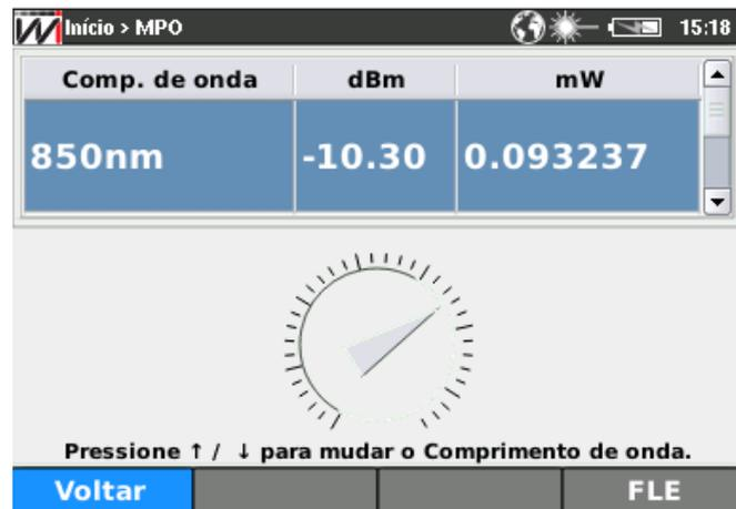
Figura 4.3.7-32: Tela do medidor de potência ótica.
