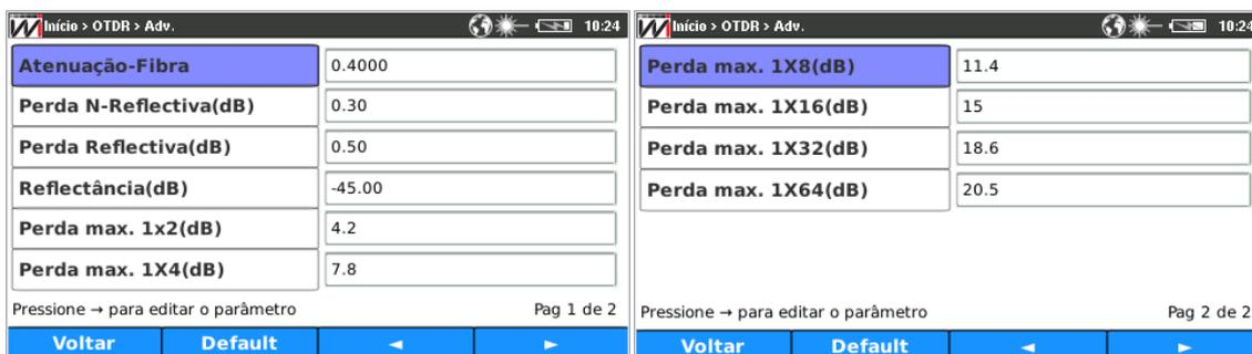
Figura 4.3.3.4-24:Limiares de Passa/falha.
