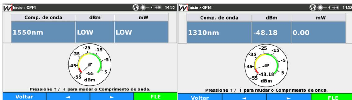
Figura 4.3.7-33:Tela do medidor de potência ótica.
