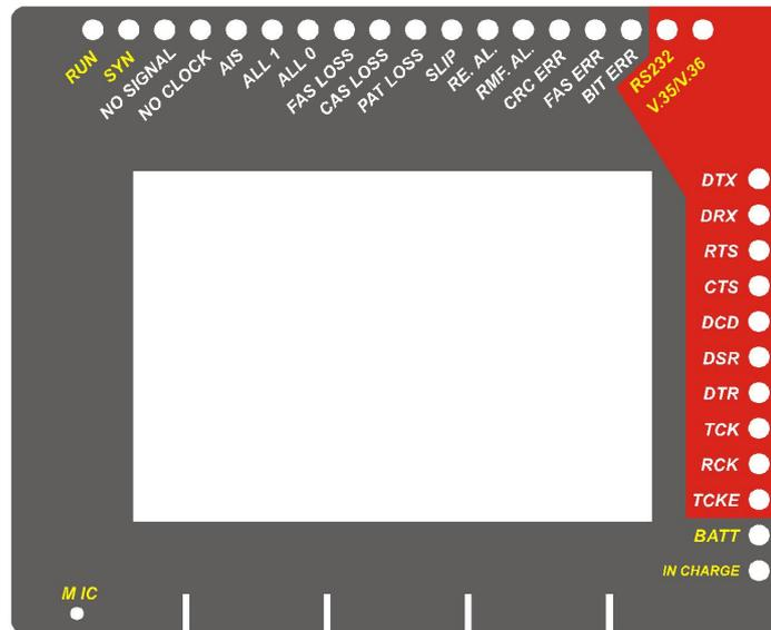
Figura 2 .2: Leds do equipamento
