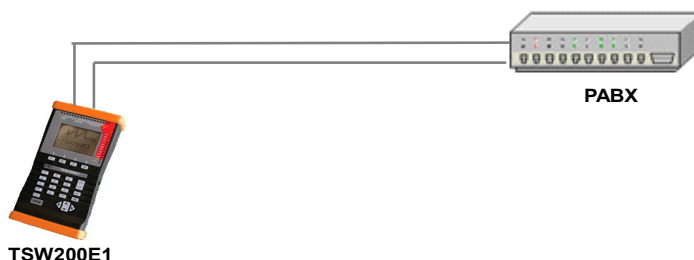
TSW200E1 emulando um terminal ISDN
