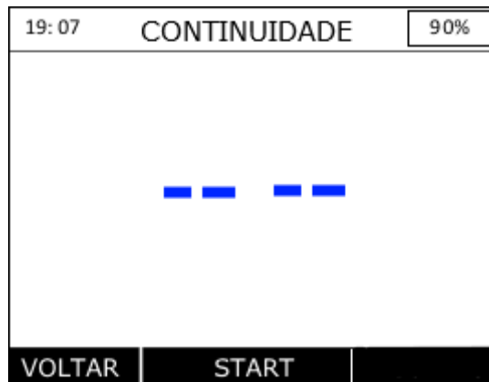
Figura 4.6: Circuito não contínuo
