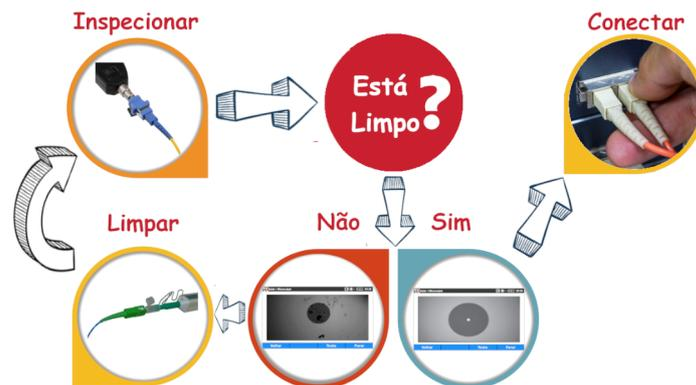
Ao selecionar o módulo microscópio no equipamento e conectar o microscópio via USB, basta selecionar o tipo da ponteira correta ao tipo de conector a ser inspecionado e focalizar a imagem no centro do conector como mostrado abaixo, se desejado, aperte o botão F3, no equipamento ou o botão teste, na tela touch screen e será iniciado um teste de Passa/Falhas no conector.
