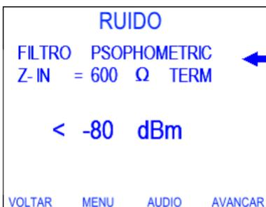
Esta tela apresenta dois parâmetros de configuração e o resultado da medição de ruído em dBm. É permitido ao usuário escolher qual a impedância de entrada (Z-IN) e que tipo de filtro será utilizado, posicionando o cursor através das teclas **▼** e **▲** na linha adequada. Para selecionar o filtro desejado, use as teclas **◀** e **▶**. Para retornar ao menu do equipamento, basta que o usuário pressione a tecla **F2** (MENU).
