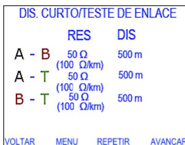
Essa medida determina a resistência do cabo e seu comprimento levando em conta a relação entre resistência e comprimento. Essa relação varia com a bitola selecionada e também pode ser editada a partir da tela *CONFIGURAR MEDIDAS* presente na tela *CONFIG*.
