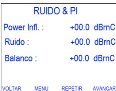
Medida que avalia o ruído gerado pela interferência de fontes AC externas ao par metálico (EMI). Esse ruído é tipicamente causado por má conexão e aterramento da blindagem do cabo. O equipamento apresenta a medida de Power Influence, Ruído e Balanco. Para retornar ao menu do equipamento utilize a tecla **F2** (MENU).
