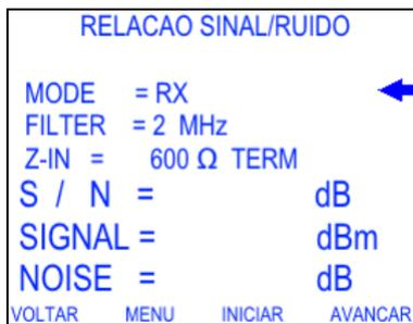
Neste módulo é possível fazer testes que revelam a relação entre a potência de sinal e de ruído na linha. São apresentadas duas opções de configuração no parâmetro MODE: TX e RX. Os modos TX e RX se relacionam entre si por um protocolo de sincronismo.
