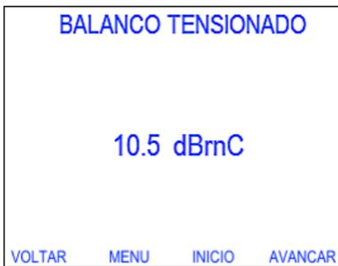
O objetivo dessa medida é encontrar diferenças elétricas, tais como resistência e capacitância, nos fios de um determinado par metálico. O intervalo de medida é de 0 a 90 dBmC, o cabo será classificado de acordo com os intervalos a seguir:
