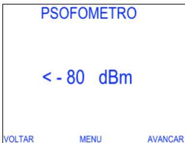
Medida que determina o nível de ruído utilizando um filtro psofométrico. O filtro psofométrico é um filtro passa-faixa de frequências de corte de  $f_1 = 500$  Hz e  $f_2 = 2000$  Hz, utilizado para aplicações de voz. Para retornar ao menu do equipamento utilize a tecla **F2** (MENU).
